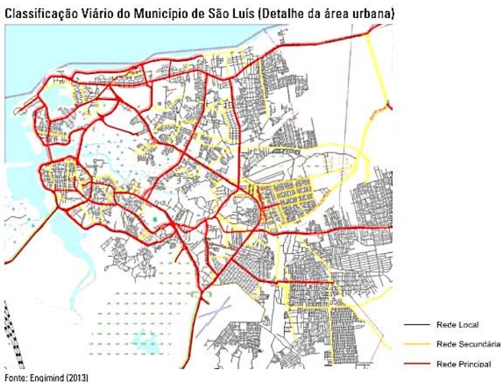
Figura 28 – Classificação viária do Município de São Luís ( Detalhe da área urbana) Fonte: BARBOSA; ESPÍRITO SANTO; TRINTA (2014, p.39)
